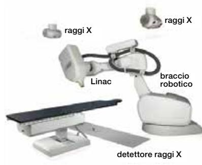
Fig. 7. L'apparato Cyberknife. Il Linac "insegue" gli spostamenti del tumore (vedi testo).
